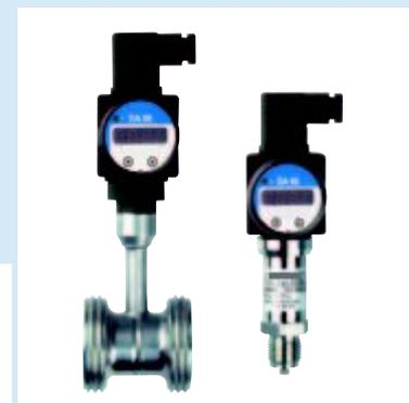
**Anwendung** Preiswertes, digitales Vorort-Anzeigegerät für alle Messumformer mit Ausgang 4–20 mA und Stecker nach ISO 4400 (DIN 43650-A). Einfache und schnelle Montage durch Aufstecksystem. Optional mit Ex-Schutz (Zone 0/1).
