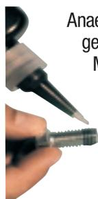
Anaerobe Klebstoffe werden direkt auf die Gewinde aufgetragen und härten nach der Montage unter Luftabschluss und Metallkontakt zu einem zähelastischen Kunststoff aus. Da der Klebstoff den gesamten Freiraum zwischen den Gewinden ausfüllt, erfolgt eine Belastungsverteilung auf der gesamten Einschraublänge und unterbindet so jegliche Bewegung im Gewinde.
