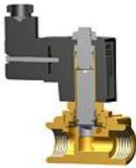
Das Ventil öffnet oder schließt direkt durch das Magnetsystem. Es ist kein Betriebs- bzw. Differenzdruck notwendig. Das Ventil schaltet von 0 bar an.
