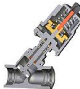
Die Ansteuerung erfolgt über ein externes Pilotventil, welches entweder direkt am Antrieb oder in der Steuerleitung montiert ist. Mit sauberem Steuermedium ( z.B. Luft, Hydrauliköl ) können die Ventile verhältnismäßig unabhängig von hohen Temperaturen, großen Betriebsdrücken und verschmutzten Medien gesteuert werden.
